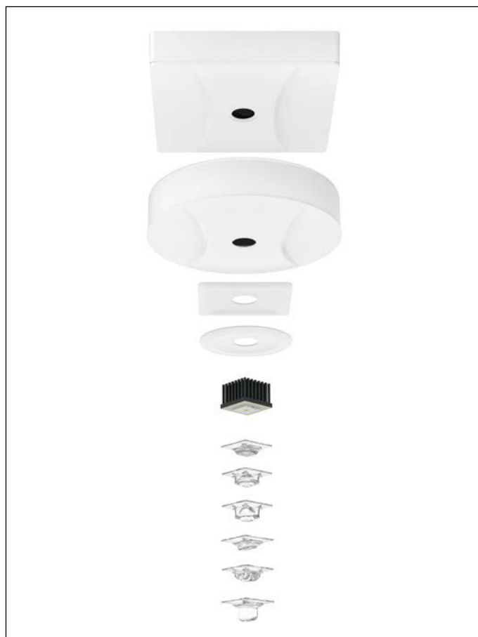
Abb.: Die Sicherheitsleuchten von Gessler sind modular aufgebaut: Der Kühlkörper von CTX wird mit den verschiedenen Gehäusen und Linsen von Gessler kombiniert. Foto: Gessler
