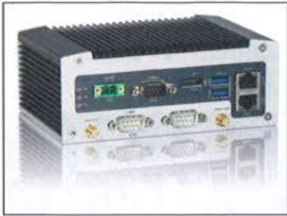
Bild 4: Mit der »KBox A-203« bietet Kontron einen Embedded-PC speziell für sehr datenintensive IoT-/Edge-Applikationen an.
