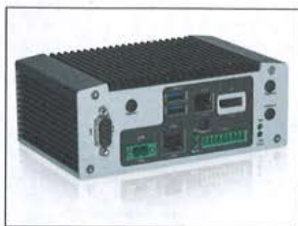
Bild 1: Der Embedded-PC »KBox A-250« von Kontron wurde speziell für IoT-Gateway-Anwendungen entwickelt.
