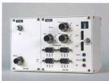
Die Modular Computing-Plattform CyBox MC-R von Eltec steuert unter anderem Anzeige- und Entertainment-Systeme in Zügen an.
