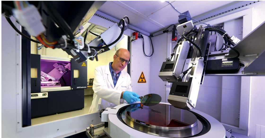
Das Fraunhofer IISB hat ein neuartiges Röntgentopografie-Gerät von Rigaku in Betrieb genommen. Dieses kann Kristalldefekte über einen kompletten Wafer bis 300 mm Durchmesser hinweg charakterisieren. Dies war auch der Startschuss für das gemeinsame Center of Expertise for X-ray Topography. Seite 8
