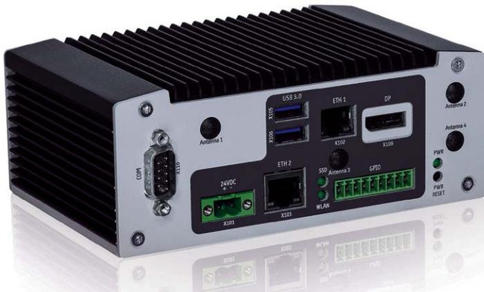
Der Embedded-PC »KBox A-250« ist speziell auf IoT-Gateway-Anwendungen zugeschnitten.
