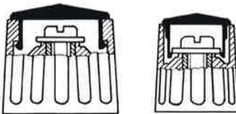
Die Deckel sind in drei Grundausführungen lieferbar: flach, Prismaform und bombiert. Die flachen Deckel mit zusätzlich aufgeprägtem Strich, Pfeil, Schwellpfeil oder mit eingeleger Aluminiumscheibe; die Prismadeckel mit aufgeprägtem Punkt; die bombierten Deckel mit Strich. Die Deckel sind so konstruiert, dass sie bei der Montage im Knopf einrasten und dadurch unverlierbar sind.
