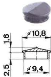
**Deckel prismaform – Capuchon prismatique – Prismatic cap**
